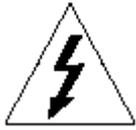
El relámpago con cabeza de flecha dentro de un triángulo equilátero intenta alertar al usuario de la presencia de “tensiones peligrosas” no aisladas, dentro del producto, que pueden ser de suficiente magnitud como para constituir un riesgo para las personas, de descarga eléctrica.
